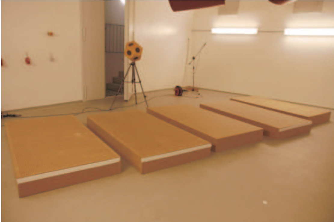
Abb. 1: Anordnung der Lochplatten im Hallraum
