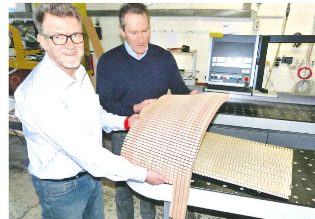
Oben: Ralf Vollmer (links), Inhaber des Unternehmens, und Biesse-Gebietsverkaufsleiter Manfred Markenbeck begutachten das Muster einer gefrästen Platte. Rechts: Eine fertig bearbeitete „Dukta“-Platte mit dem Fräsmuster „Sonar“ in regelmäßigen Längseinschnitten
